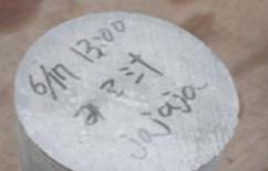
コンクリートに混ぜる水を、廃棄する別ものに変えたらどうなるの?例えば、カップ焼きそばを作ったときに出るお湯を再利用してコンクリートが造れたらSDGsになるのでしょうか?廃棄するはずだったものを水の代わりに使って実際に練ってみよう!
